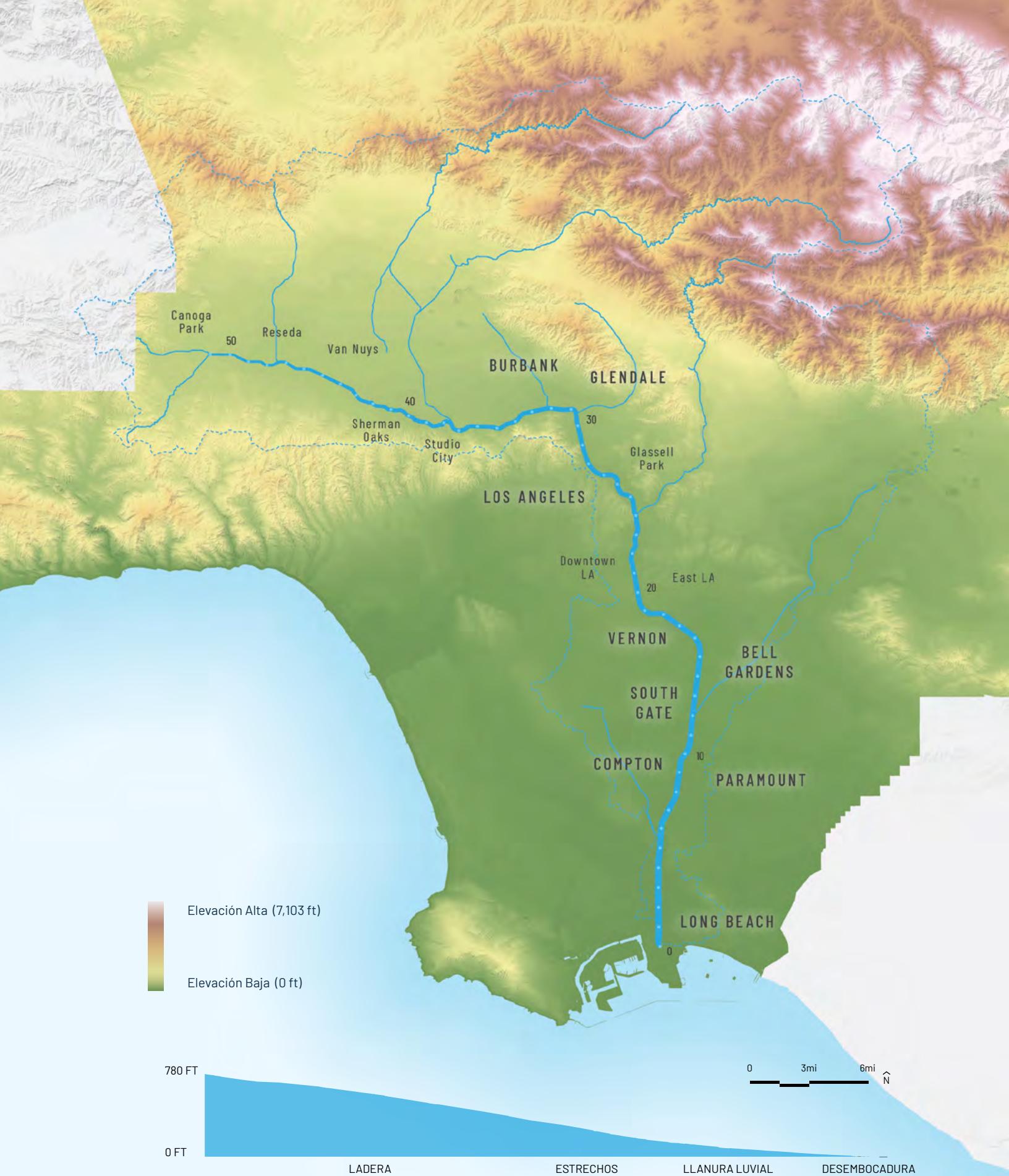
Figura 38. MED del Condado de Los Ángeles (Modelo de Elevación Digital). El Río de Los Ángeles cae 780 pies en solo 51 millas. Fuente: U.S. Geological Survey, 2013; USGS NED 1 arc-second 2013.
